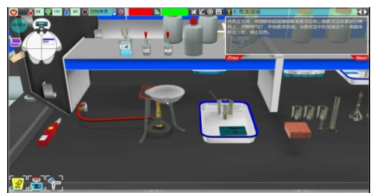
18.等待溶液尽干，停止煤气加热，取下蒸发皿
