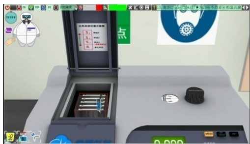
35.将盛有溶液的比色皿放入分光光度计
